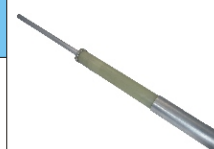
Rura izolacyjna, wsporczą RSE40, M40 z iglicą 16 x 1m do HVI.
